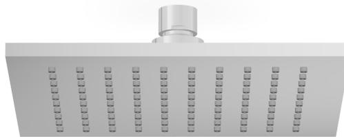
Soffione 200x200 mm in ottone, a getto fisso, con sistema anticalcare. Spessore 8 mm. Ispezionabile. Water Saving - portata d'acqua uguale o inferiore a 9 l/min.
