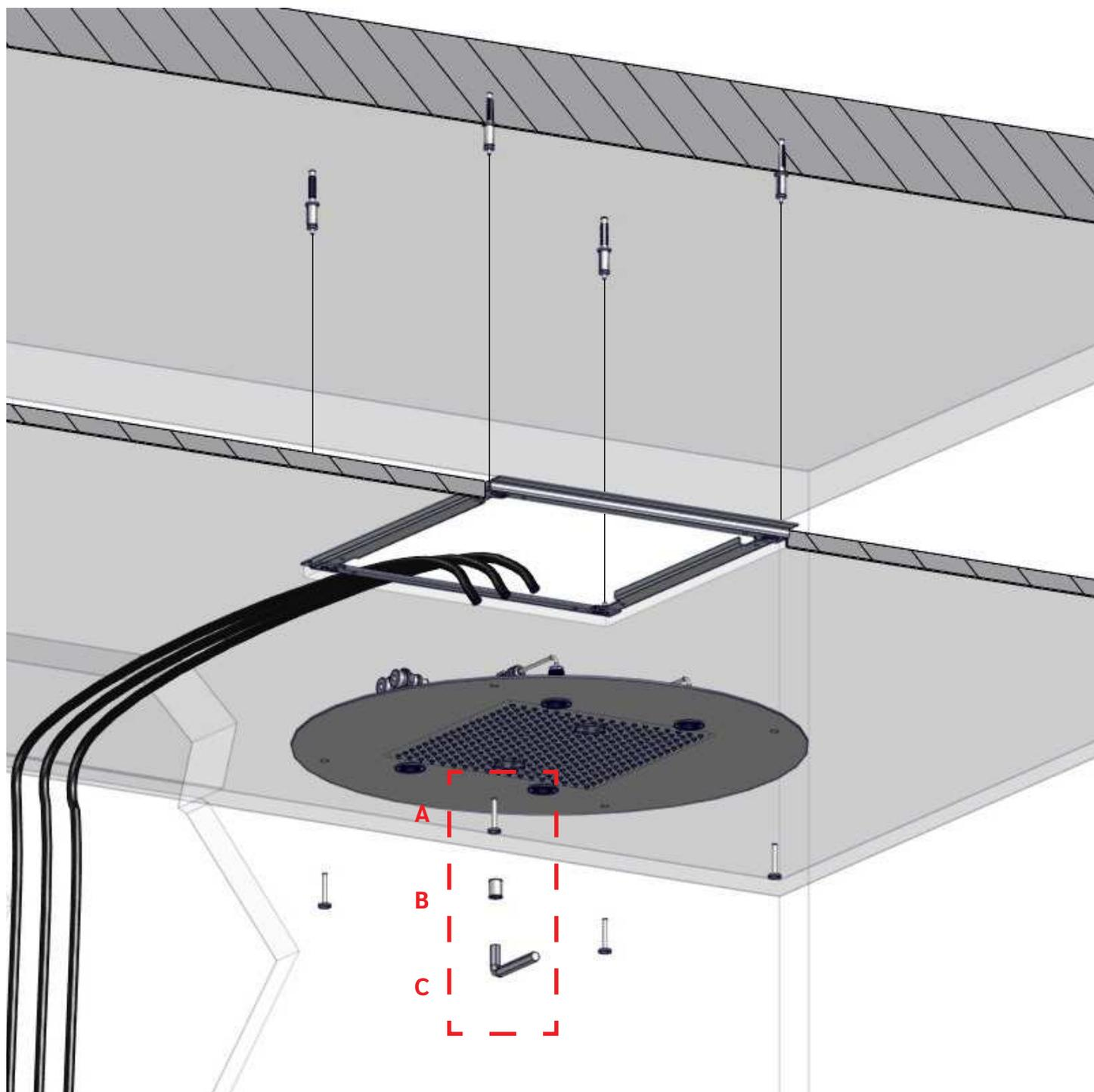
Una volta fissati i collegamenti elettrici ed idraulici, avvitare la vite (A) tramite il raccordo (B) con chiave esagonale 10mm fino a completo serraggio.
