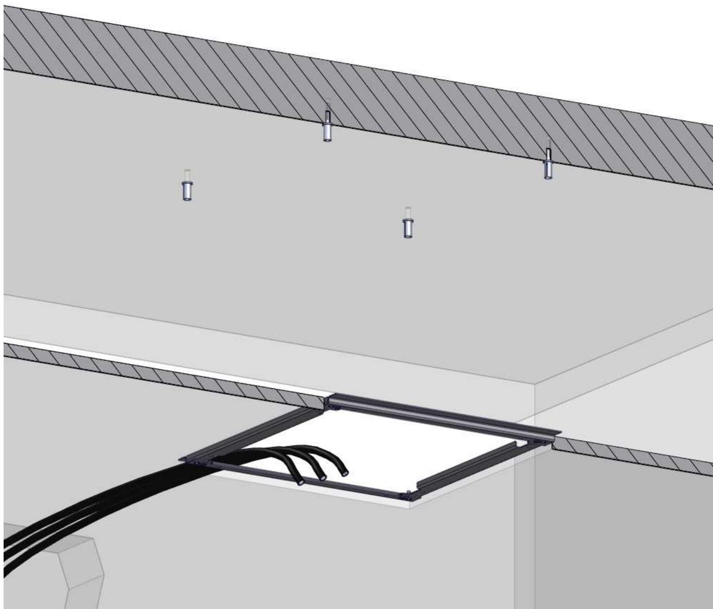
Inserire nella spaccatura la piastra di fissaggio del soffione, che deve risultare appoggiata al piano del controsoffitto.
