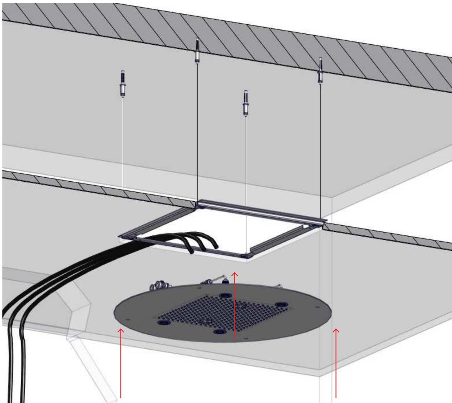
Avvicinare il soffione verso la piastra di fissaggio per andare ad effettuare i collegamenti idraulici e/o elettrici.
