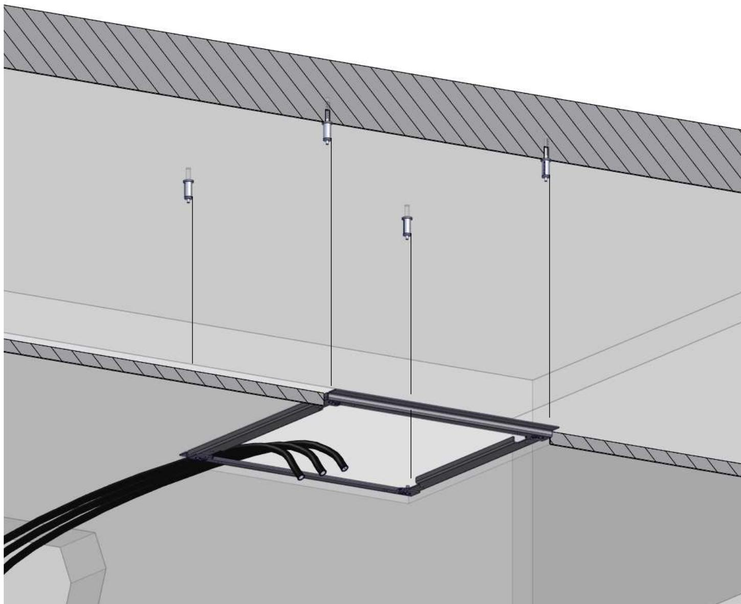
Il peso complessivo della struttura deve essere sorretto dai tiranti, che sono fissati al soffitto, mentre la piastra di fissaggio deve risultare appoggiata al controsoffitto.
