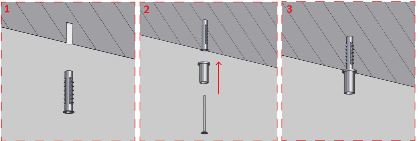
Praticare nel soffitto i fori alla distanza indicata, centrati rispetto allo spacco del controsoffitto. Montare il kit di fissaggio inserendo il fischer nel foro del soffitto (figura 1). Infilare la vite nella boccola (figura 2) ed avvitare fino al completo bloccaggio del kit (figura 3).
