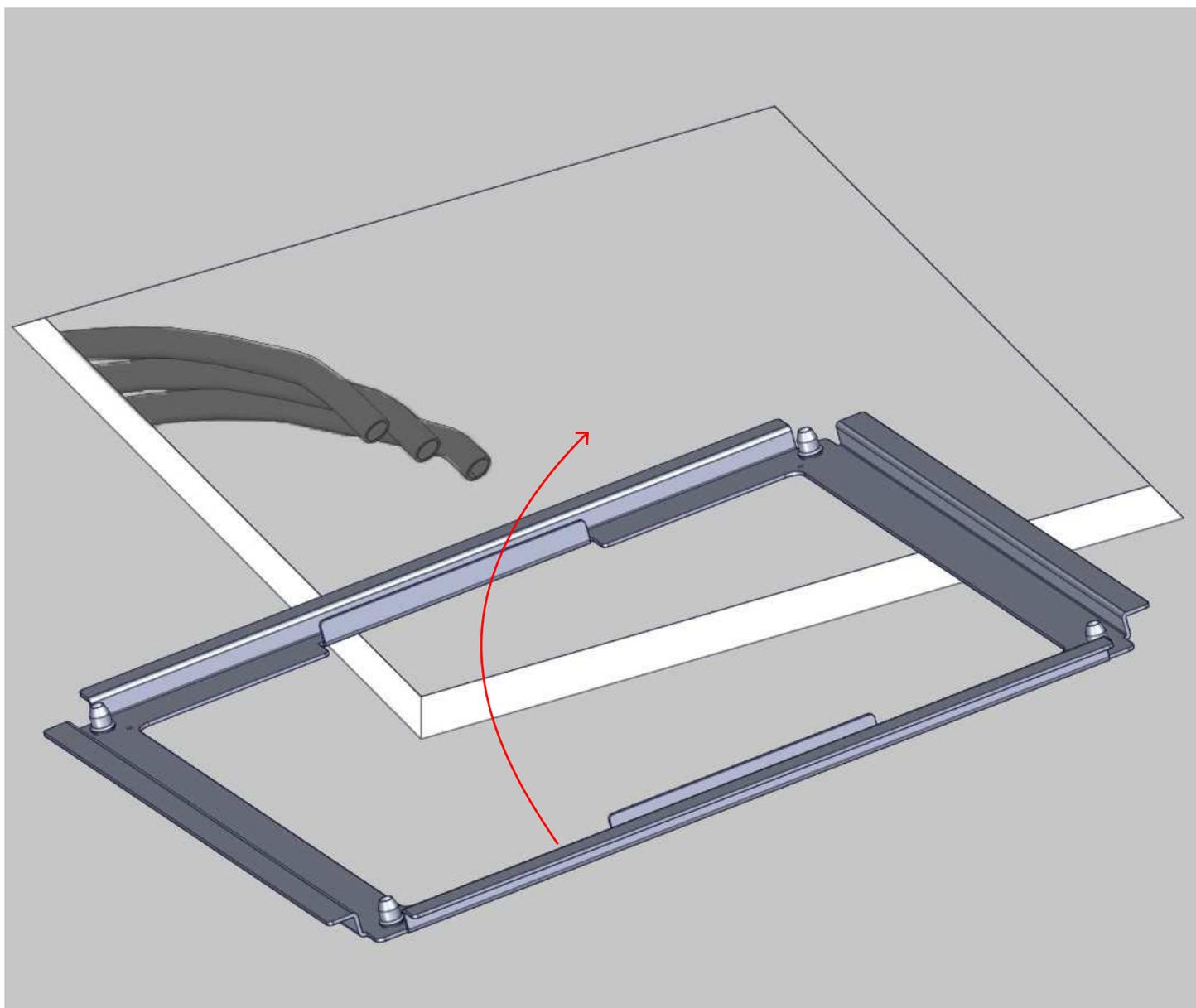
Inserire nella spaccatura la piastra di fissaggio del soffione come mostrato in figura.
