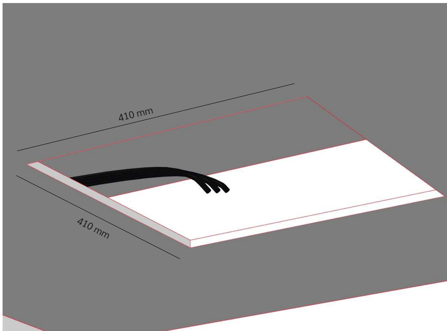
Praticare nel controsoffitto una spaccatura come mostrato in figura per l'inserimento della piastra di fissaggio del soffione. **ATTENZIONE!** Predisporre nel controsoffitto N tubi in base a quanti sono gli ingressi nel soffione; per collegamento idraulico ed elettrico. (img. esempio)
