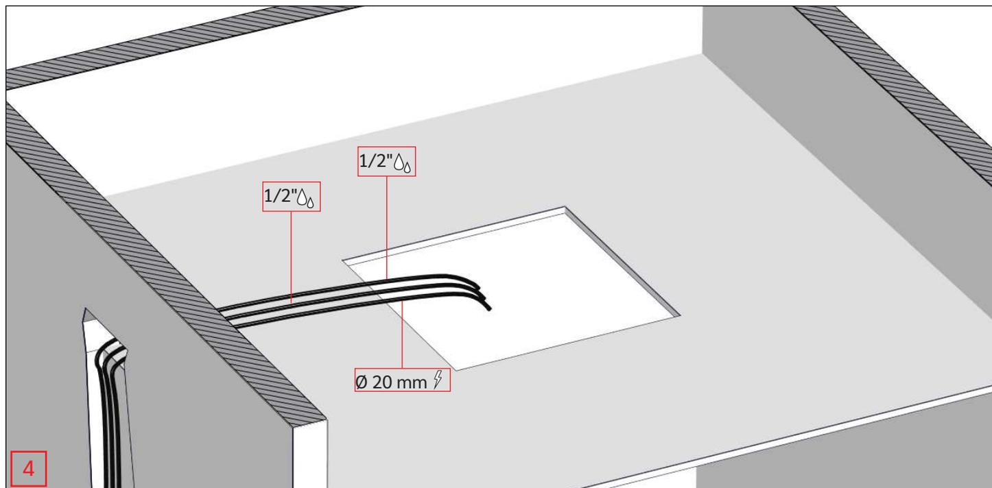
3. Passaggio tubo da 1/2" per soffione 1 getto, con tubo corrugato da Ø 20 mm per alimentazione faretti (se presenti).
