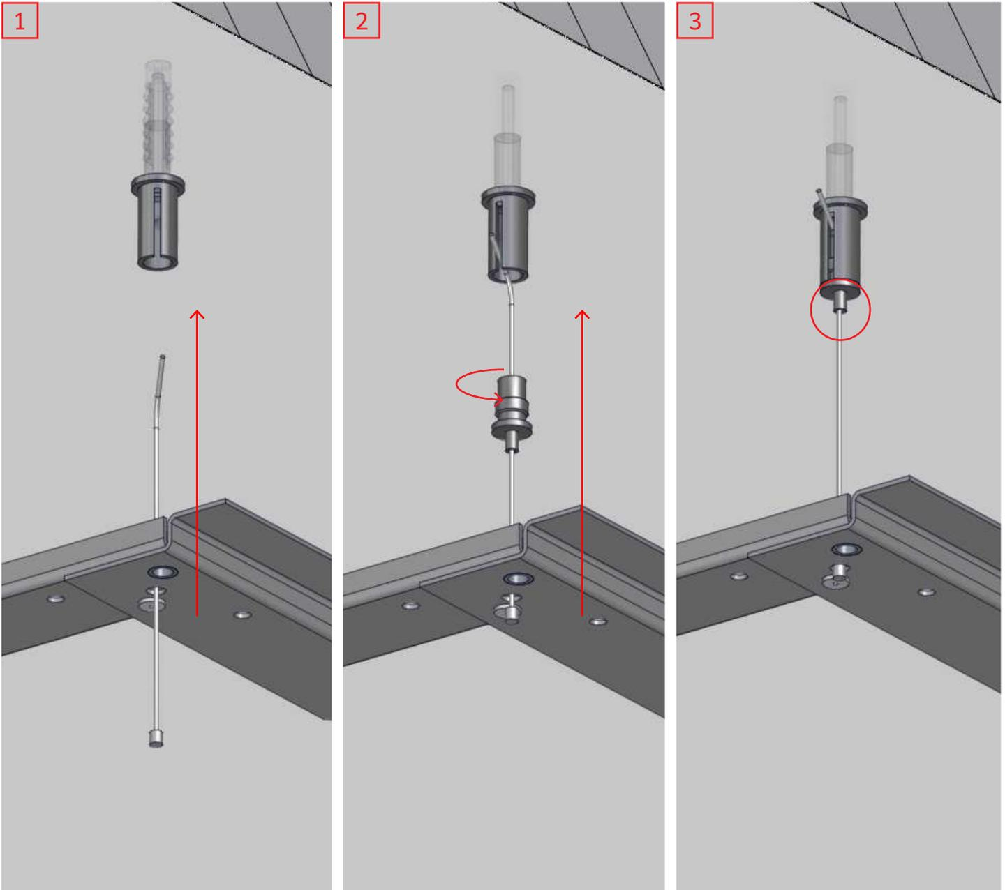
Inserire il tirante nel foro della piastra e infilarlo nel tenditore (figura 1). Inserire il tenditore nella boccola precedentemente fissata nel soffitto e avvitarlo fino al completo serraggio (figura 2). Per regolare la lunghezza del tirante, tirarla fino alla misura desiderata. Per sbloccarla premere il piolo (figura 3). **ATTENZIONE!** Il tirante deve essere teso senza però sollevare la piastra di fissaggio. Ripetere l'operazione per ultimare il fissaggio.
